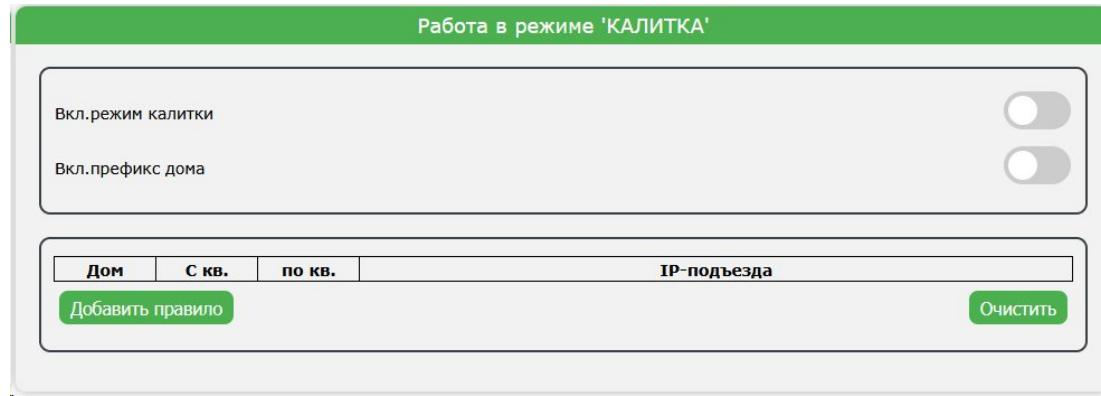
**При установке домофона на калитке достаточно указать диапазон квартир и IP-адрес панели подъезда.**
